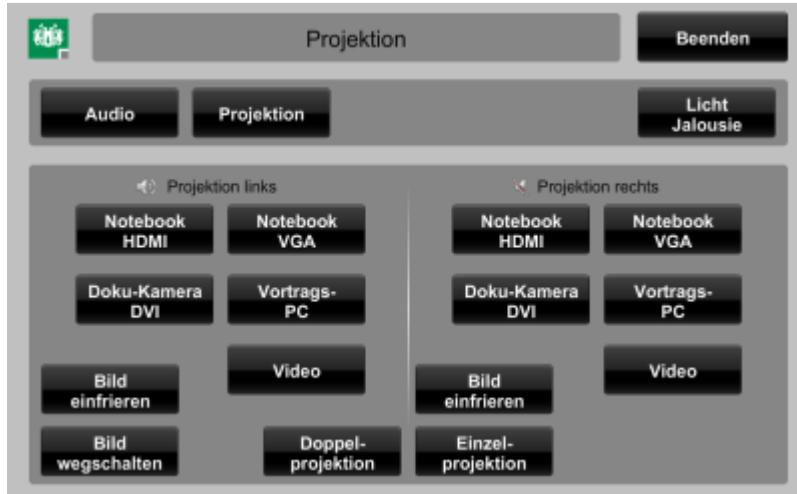
Bei einigen Szenarien gibt es Untermenüs, zwischen denen man umschalten kann, um weitere Einstellungen vorzunehmen. In diesem Beispiel sind das die Menüpunkte: „Audio“, „Projektion“ und „Licht Jalouse“. Im Menü „Audio“ beispielsweise, lassen sich die Mikrofone leiser, lauter oder stumm (mute) schalten:
