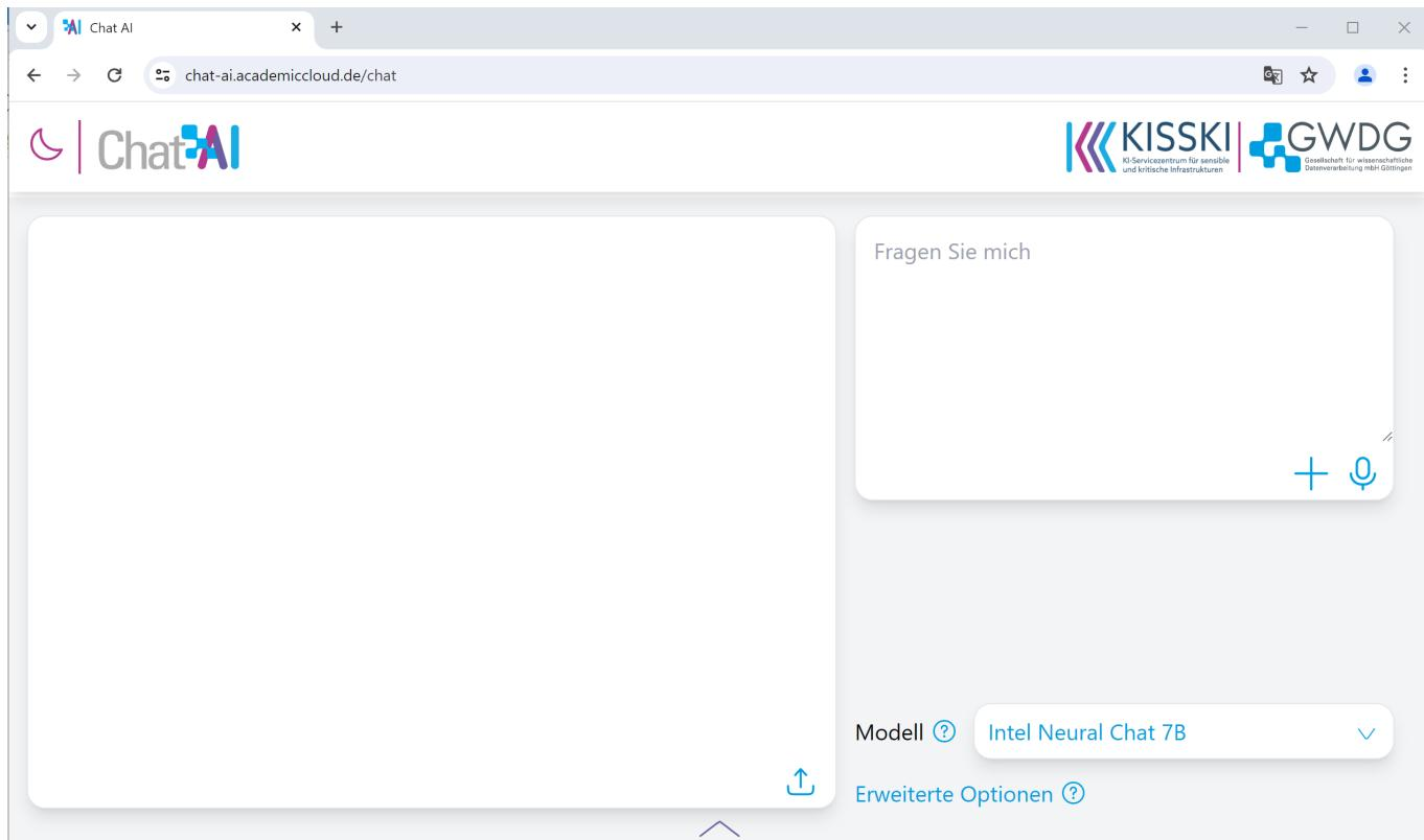
Bei „Modell“ können Sie eines der angebotenen Sprachmodelle auswählen. Bei den mit Modellen von OpenAI erfolgt eine Datenübermittlung an externe Rechenzentren. Die anderen Modelle werden lokal bei der GWDG betrieben. Durch einen Wechsel der Modelle können Sie deren Antworten vergleichen und Stärken und Schwächen erforschen.
