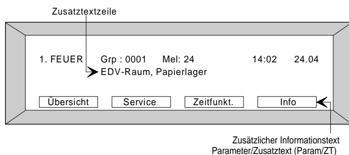
Abb. 31: Displayanzeige Beispiel zur detaillierten Zustandsanzeige Feuer
