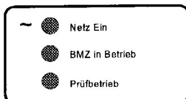
Abb. 2: Betriebszustandsanzeigen
